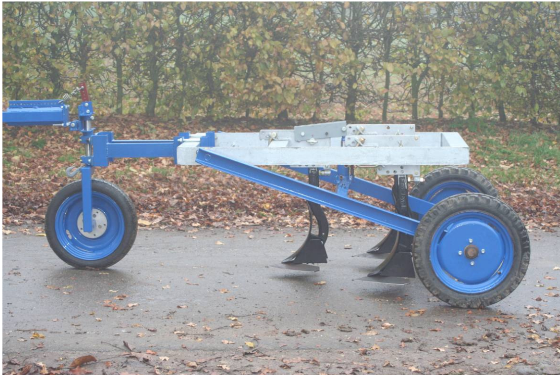
Prototyp eines Grubbers für pfluglose Bodenbearbeitung mit Arbeitspferden aus 2008, Projekt „Humussphäre“
